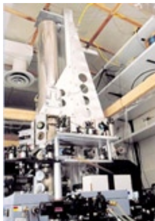
Gambar 8.8 Jam atomik menggunakan atom cesium
